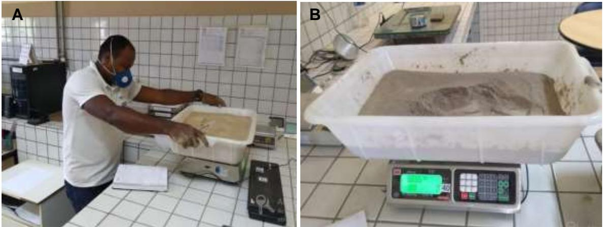
Foto 2 - Etapa de mistura das massas argilosas com resíduo (c) e conformação da massa (d)
