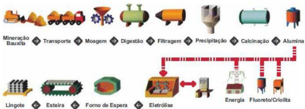
Figura 1 – Fluxograma de Obtenção do Alumínio
