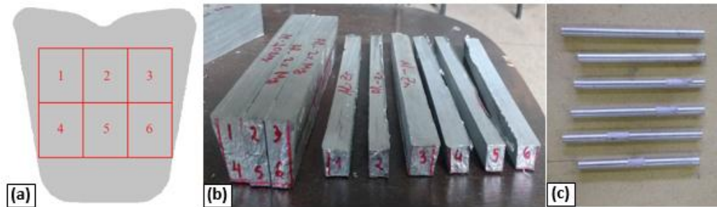
Figura 50 – Processo de Corte dos lingotes: modelo (a), amostras cortadas (b) e amostras usinadas(c)
