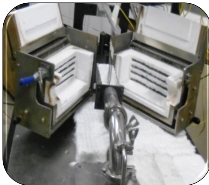
Figura 3.11. Registro fotográfico do interior da lingoteira, mostrando in loco detalhes das resistências elétricas e o conjunto chapa molde e lingoteira.
