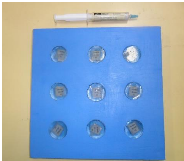
Figura 3.19. Corpos de prova para análise microestrutural durante o embutimento a frio.
